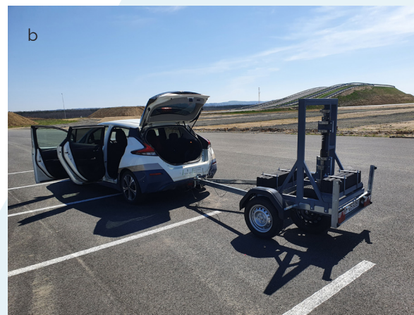
7. ábra. Gördülési súrlódást mérő berendezés modellje (a) és az elkészült berendezés (b)
