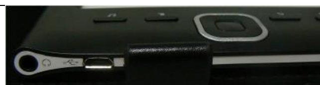
alsó rész: csatlakozók (a microSD kártyahelyet a microUSB csatlakozás mellett jobbra található, a bórtok rögzítőfüle takarja)
